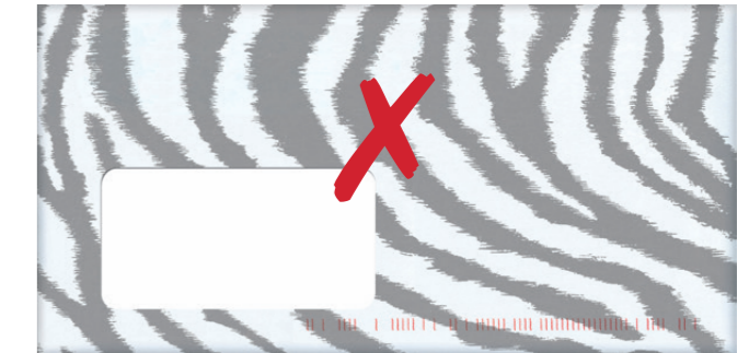
Abfallender Druck bis in die Codierzone ist zu vermeiden, die Ruhe- und Codierzonen müssen unbedruckt und unbeschriftet sein
