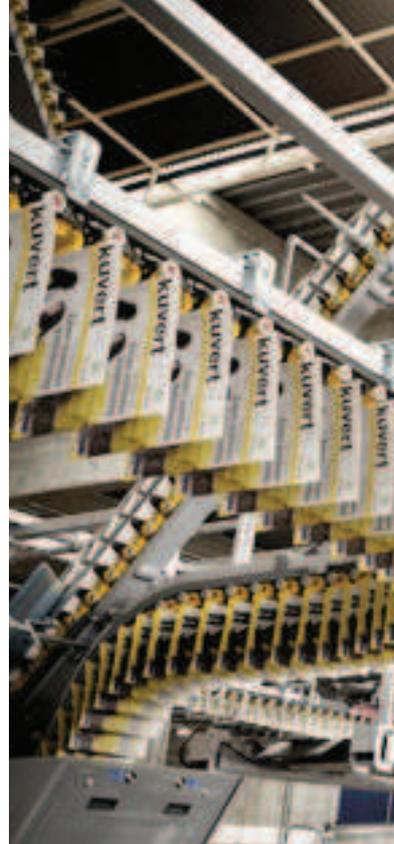
„Collatoren“ ermöglichen die maschinelle Bündelung von unadressierten Werbesendungen und werden zur Konfektionierung eingesetzt
