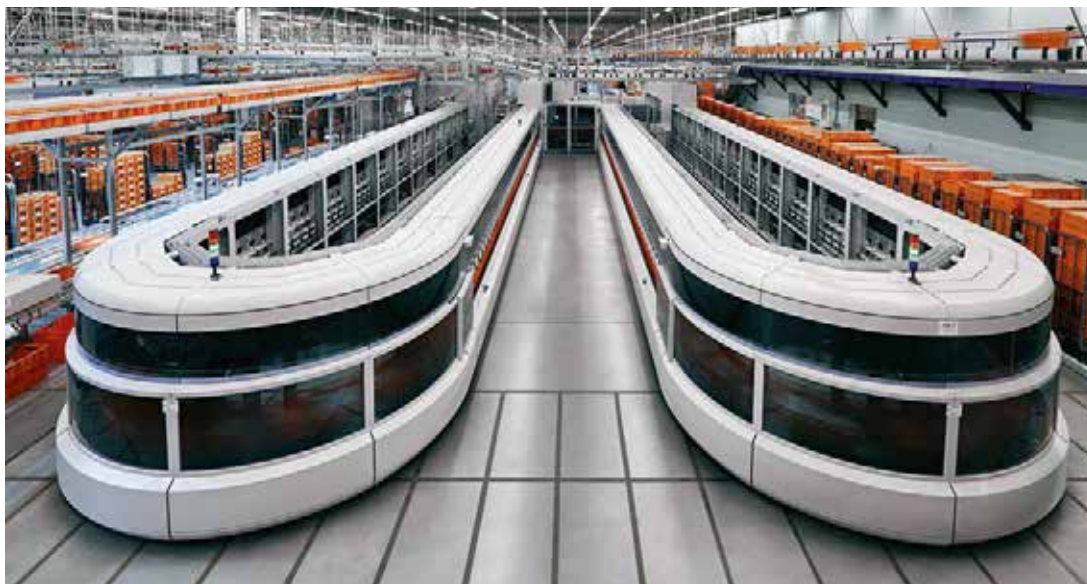
Ein einzelner „Flatsorter“ bearbeitet bis zu 38.000 Sendungen pro Stunde.
