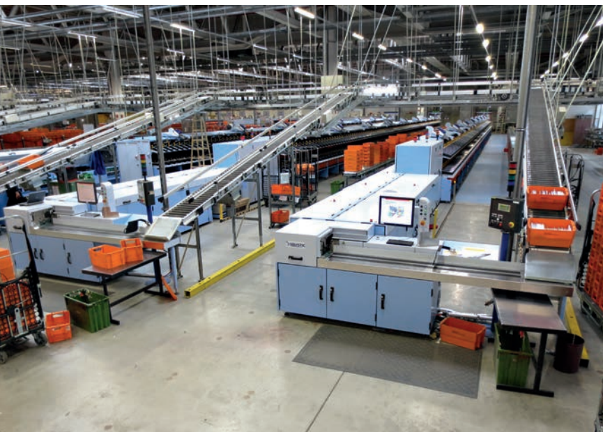
Bis zu 46.000 Briefe verarbeitet eine moderne Briefsortieranlage in einer Stunde.
