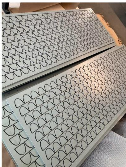
Die Form wird ausgefräst
